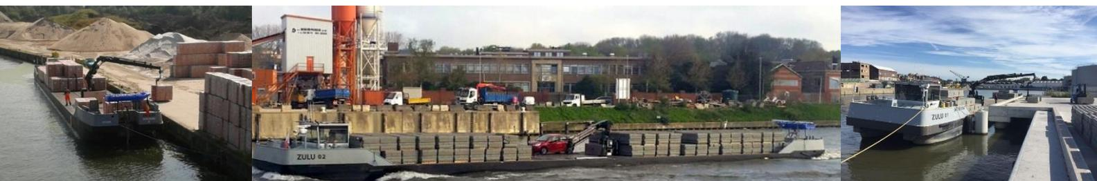
Blue Line Logistics conçoit des barges fluviales adaptées au transport de palettes et équivalent. Équipées d'une grue se déplaçant sur 2 rails, ces barges peuvent prendre ou déposer dans des Ports bien sûr, mais aussi sur de petits espaces bord à voie d'eau, des haltes fluviales.
