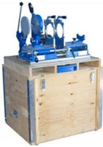
Soudeseuses tubes plastiques avec caisse de transport (Ø40 à Ø160 mm)
