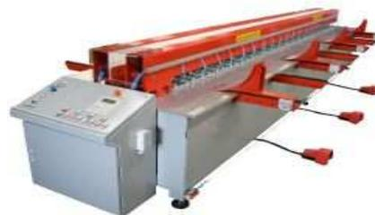
Les machines semi-automatique pour soudage des plaques et des viroles de cuves
