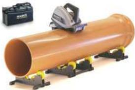
Scie portable pour tubes plastiques PE/PP/PVC/PVDF (Ø90 à Ø400 – Ep22)
