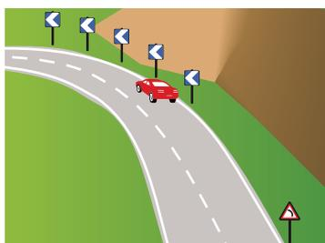
Sur les routes bidirectionnelles situées hors agglomération, l'importance de la signalisation implantée est fonction du risque encouru par l'usager de la route dans le virage. Il existe quatre séquences de signalisation en fonction de l'importance croissante de ce risque :
