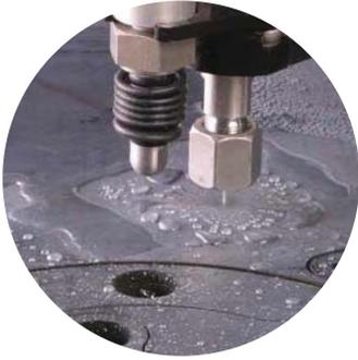
Toutes les pièces d'assemblage sont réalisées par découpe à l'eau avec une précision de l'ordre de 1/1000 de millimètre.
