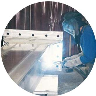
Nos soudures longitudinales sont réalisées par des bancs de soudure automatique. Les soudures d'angles et de bout-à-bout par nos soudeurs qualifiés EN287-2
