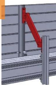
Nos profils permettent de fixer les I de fixation des panneaux dans une gorge prévue à cet effet. De plus, nous pouvons aisément fixer à l'arrière un deuxième I sur lequel vient se fixer le renfort arrière du panneau.
