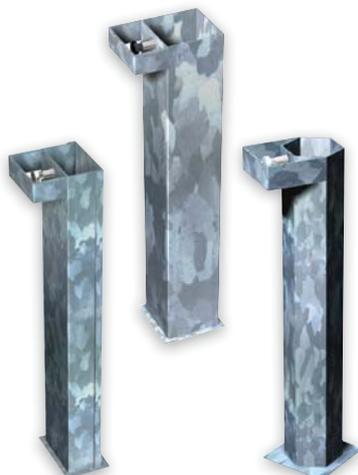
**Fourreau en acier galvanisé**, fermé en bas afin d'éviter la remontée béton. Perçage pour l'écoulement des eaux de ruissellement. Support équipé d'un manchon fileté en aluminium et d'un boulon standard inox  $\varnothing$  8 mm. Réserve pour le passage de la clé de 13 et la mise en place du boulon.
