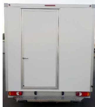
Porte arrière simple excentrée avec poignée int / ext et fermeture à clé, blocage magnétique à 180°
