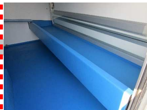
Bac polyester derrière auvent avec trous d'écoulement et angles arrondis
