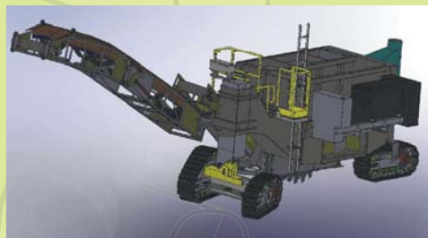
Etude de conception d'une trancheuse de routes (matériel TP)
