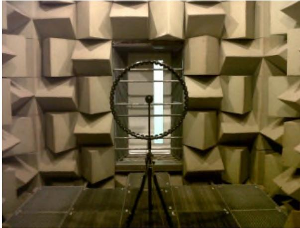
*Salle anéchoïque : positionnement antenne acoustique*
