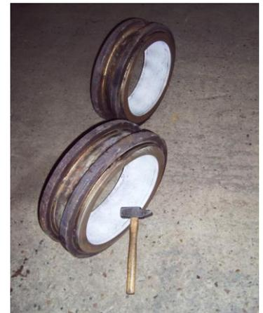
Vis de transport rechargées avec un cordon Ni-Cr chargé à plus de 60% de carbure pour tenue à l'abrasion
