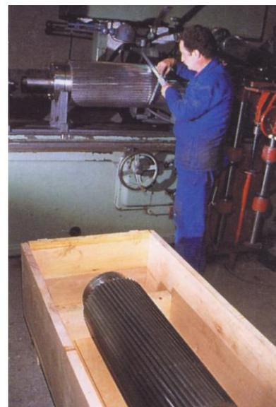
Rotors de découpe rechargés au plasma arc transféré avec stellite Grade 12.
